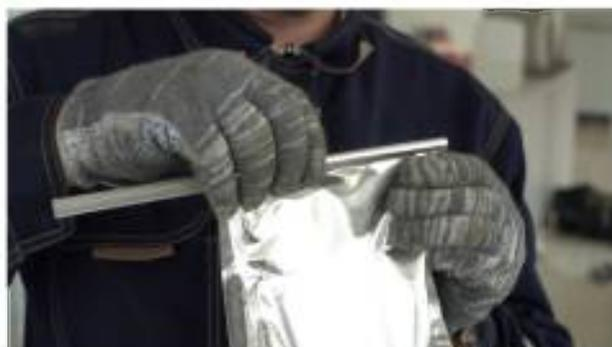
**4. Интенсивно взболтать пенопакет в течении 20 – 30 секунд.**
